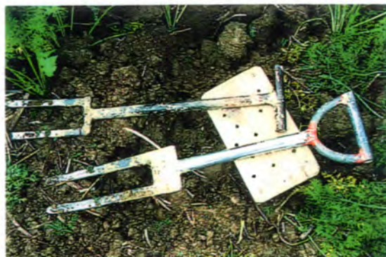
周りの土だけを取れるようにした専用のスコップ。自動車のスプリングを溶接して作った。
