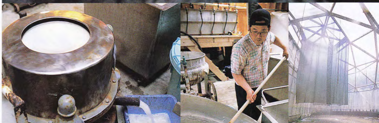
ドームの中で海水を濃縮し、その後釜で炊いて、結晶を作る。そして遠心分離器にかけると塩とにがりに分かれる。にがりは横浜の豆腐屋さんに売られていくのだという。
